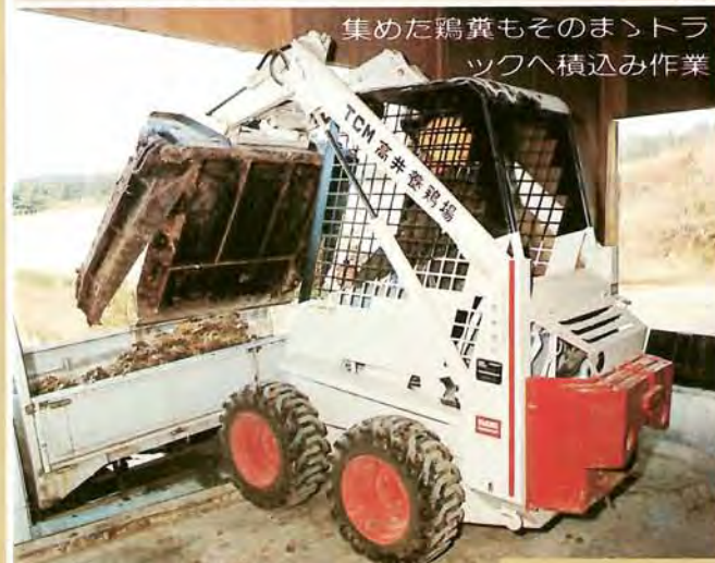
ウイングバケットを付けてケージ下の鶏糞も残さずきれいにクリーンアップ
