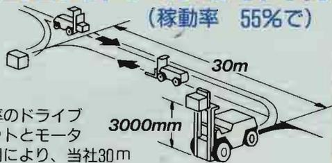
高効率のドライブユニットとモーターの採用により、当社30m作業サイクルパターンで従来車に比べ、稼働時間を35%も延ばしました。一般的な使い方（稼働率55%）で一日8時間の使用が可能です。
