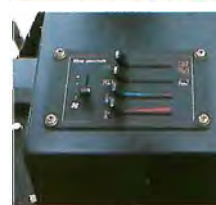
エアコン操作パネル
