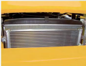
大容量ラジエータ、別置きオイルクーラーの採用で冷却効率アップ。
