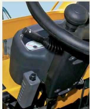
アクセルを踏み込んでいくと、最高速まで自動的に変速を行うオートマチックトランスミッションを採用。従来のわずらわしい変速操作の必要がなく、滑らかな発進、加速による優れた機動性を発揮します。また、前後進の切り換えは軽い操作の電気式チェンジレバーで、スムーズに行えます。
