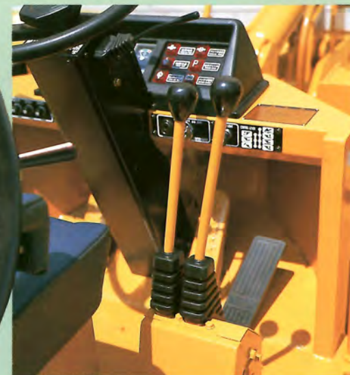
操作レバー(バルブレバー)にゴムブーツを追加 バルブレバー部にゴムブーツを追加して商品性を向上しました。
