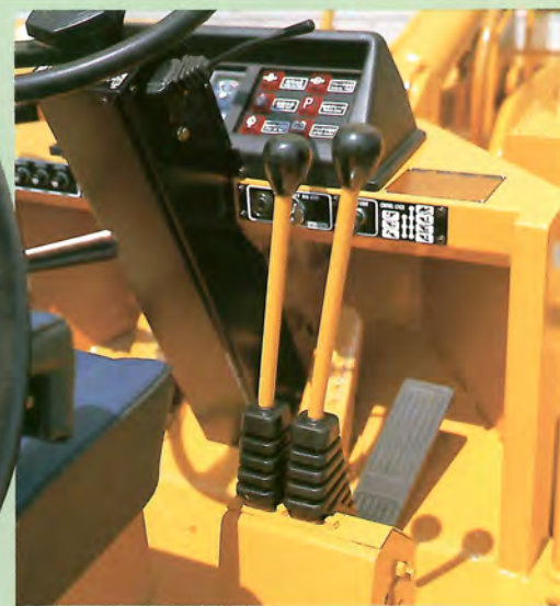
操作レバー(バルブレバー)にゴムブーツを追加 バルブレバー部にゴムブーツを追加して商品性を向上しました。
