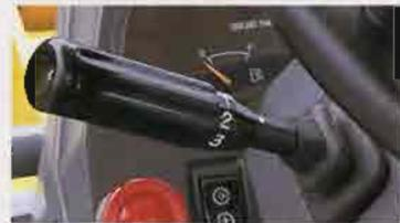
前後進・\*4段変速ともにモジュレート機構を採用し、操作は軽くフェューアタッチが自慢。ショックの少ない、快適な運転を約束します。
