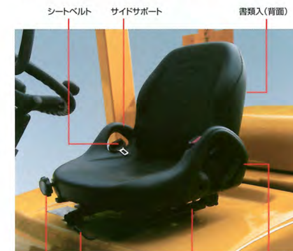
体重調整ノブ 前後位置調整レバー サスペンション機構 リクライニングレバー
