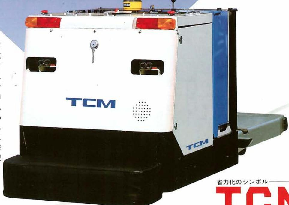
生産工場の組立ラインや配送センターなどの物流拠点で、FA、FMSの導入が急速に高まっている中で今、総合物流を目指すTCMが、カート車やスキッドなどを無人搬送する'ローリフトタイプ'の無人ローリフトトラックを開発。定評あるメカトロニクス技術を駆使したフレキシブルな無人搬送システムASTシリーズは、必要なものを、必要な量、必要な時に、生産工程へ供給します。工程間のつなぎ運搬、工程と倉庫間の搬送、空カート車の回収など多様なニーズにも対応できる最適システムの提供で、物流の合理化に大きく貢献します。
