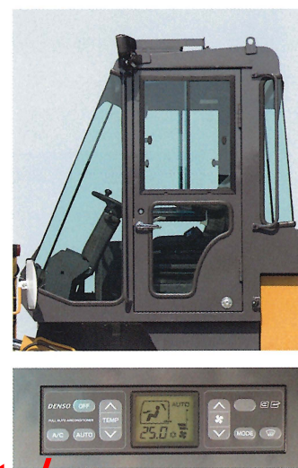
エアコン操作部
