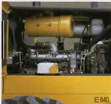
E835/840は、総排気量をアップ。またE830/840はターボエンジンを搭載。更にすべてのエンジンが、燃料噴射時期や噴霧の最適化、燃料室形状の改善などにより、排出ガスをよりクリーンに。炭化水素(HC)、窒素酸化物(NOx)、一酸化炭素(CO)、黒煙などの量が建設省排出ガス規制の基準値をクリアしています。
