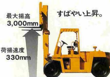
高所作業をラクラクとこなす最大3,000mmの揚高。加えて、荷揚速度は毎秒330mm(無負荷)と速く、荷物の積み降ろしがとてもスピーディーにできます。
