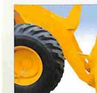
除雪作業時などでの荷役装置の損傷を防止するため、boom plateの形状、材質を改良し信頼性を向上しました。
