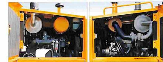
旧シリーズよりサイドパネルを大型化し、点検のしやすい構造としました。さらに通常行う日常点検箇所は片側に集中配置され、点検が地上から容易に行えます。
