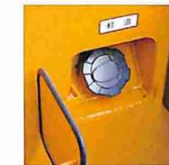
燃料給油口を後方へ移動し、給油しやすくしました。また、カバーを追加し粉塵・雪などの付着を防止しました。
