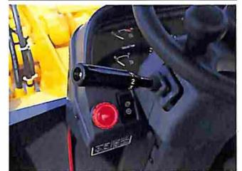
操作は軽くフェザータッチが自慢。前後進・3段変速ともにモジュレート機構を採用しショックの少ない快適な運転を約束します。
