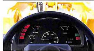
車両の状態が一目でわかる新型クラスタメータを採用。メータ類はアナログ針で視認性がよいため、操作中でも確実に車両の状態が確認できます。
