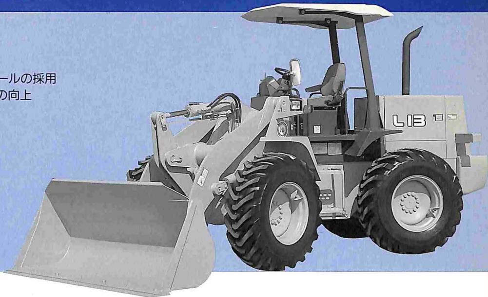
※転倒時、および落下物からオペレーターを保護する構造のキャビン
