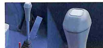
荷役作業は、操作が簡単でミスのない、モノレバー方式を採用しています。
