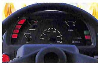
車両の状態が一目でわかるクラスメータを採用。メータ類はアナログ針で視認性がよいため、操作中でも確実に車両の状態が確認できます。
