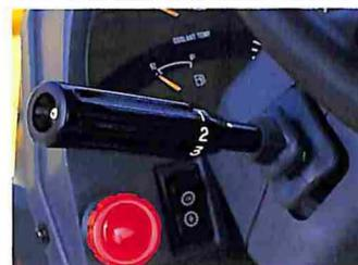
操作は軽くフェザータッチが自慢。前後進・4段変速ともにモジュレート機構を採用しショックの少ない快適な運転を約束します。
