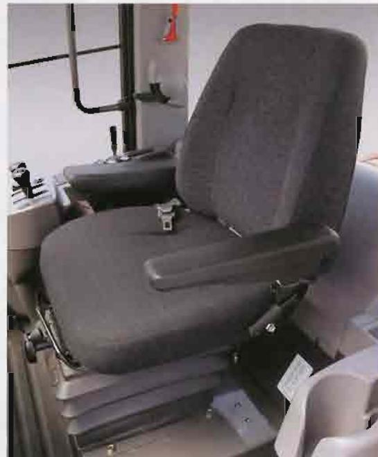
ボディから伝わる衝撃を受け止めるシートは、その性能がオペレータの肉体的なストレスに最も大きく影響します。そこで不快な振動を吸収するサスペンションシートを採用し、身体への負担を低減しつつ、快適性を確保しています。
