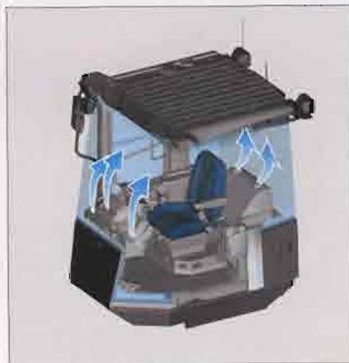
フロント3カ所、フロントサイド2カ所、リア2カ所のデフロスタを標準で装備。雨天時や寒冷時に発生しやすいガラスの曇りを除去し、視界を良好に保ちます。
