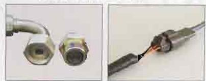
高圧配管部分には、航空機にも使用されているORS継ぎ手を全面的に採用。ORS継ぎ手は、すでに日立の油圧ショベルZAXISでも採用実績があり、その高い信頼性には定評があります。また、電装配線の接続部分には、信頼性に優れた防水コネクタを採用。トータルな耐久性を高めました。
