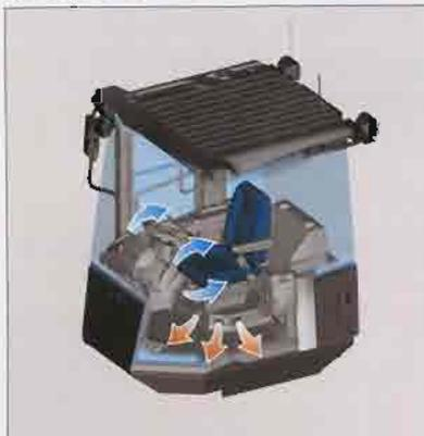
温度設定によって、風量や吹き出し口、温度を自動的にコントロール。さらに、足下を暖かく、顔部分を冷やすといったように、場所によって温度を変えることができるバイレベル機能を搭載。前方からの吹き出し口は自由に角度調整可能で、顔や体に直接風があたり、暑い時期の快適性を実現します。また、キャブ内の気圧を外部よりわずかに高めた加圧キャブは碎石現場などで発生する非常に細かい粉じんの侵入を防ぎ、キャブ内を清浄に保ちます。
