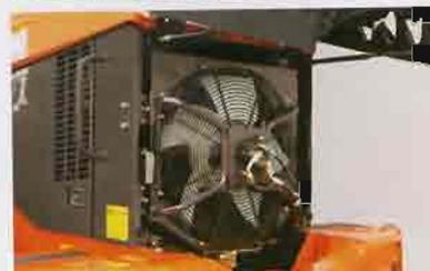
冷却水、作動油を冷却するためのファンに、温度を感知して無段階に回転速度を制御する温度感応型油圧駆動ファンを採用。きめ細かな冷却が可能になることで、各コンポーネントや部品の長寿命化に貢献します。燃費の面でも有利です。また、エンジンと分離された独立駆動となっているため、メンテナンス性の向上にも寄与します。
