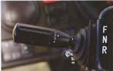
作業内容によって最高速を4段階に選択できるフルオートマチック型HSTを採用しました。変速時のショックが無くスムーズな動きを実現します。
