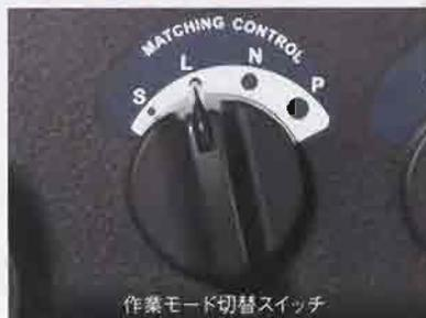
ZW150では、作業内容やオペレータの操作の好みに応じて選択できる4つの作業モードを用意しています。各モードは、独自に開発した業界初の電子制御式マッチングコントロールが作業機の油圧を検知し、走行用油圧モータのトルクを制御。4つの作業モードすべてで、けん引力と掘起力をベストマッチングさせます。これにより、オペレータの操作の好みに柔軟に対応し、扱ひ物によりモード変更することで、燃費あたりの作業量の増大も可能となりました。
