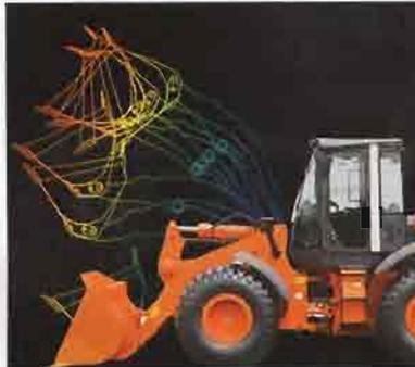
新パラレルタンデム回路の導入により、従来機ではできなかったリフトアームとバケットを同時に動かす複合動作が可能になりました。掘削や積込みといったフロント作業を効率良く、スムーズに行えます。
