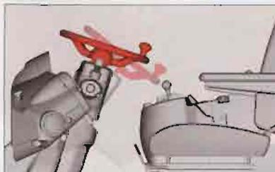
ステアリングホイールには、角度を調整できるチルト機能。右コンソールには、操作レバーの位置を前後に調節できるスライド機能。シートにも前後に調節できるスライド機能、オペレータの好みや体格にも柔軟に対応します。
