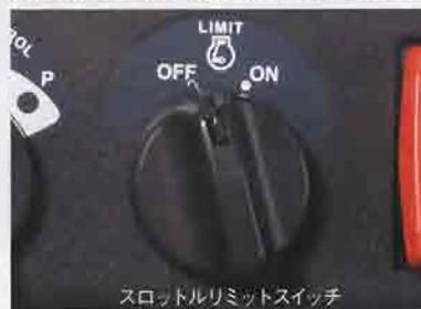
エンジンの最高回転数を10%抑えるスロットルリミットスイッチを搭載。HST車の場合、回転数を抑えても最大けん引力を発揮します。燃費の向上に効果があります。
