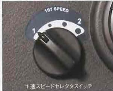
1速の最高速を作業内容に応じて4段階に選択可能。積込み作業などで現場の広さに応じた車速を選択することにより、微妙なアクセルやブレーキ操作が不要になります。
