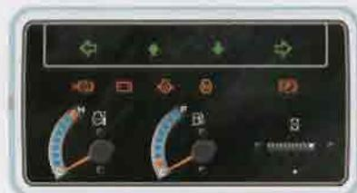
一目で車両の状態を把握できる、見やすい透過式メータパネルを採用しました。計器類の位置は適所に集中レイアウトされ確認しやすくなっています。
