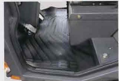
キャブはドア周辺のデザインを変更して段差のないフラットなフロアにしました。ほうきで掃くだけの手軽な作業で、キャブ内の掃除が可能です。
