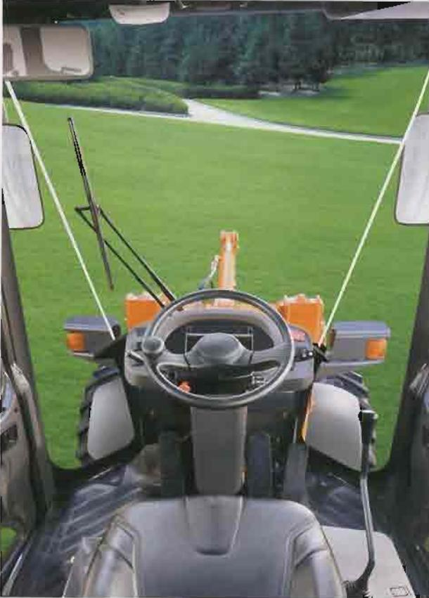
フロントの大型ガラスとドアには大型スライドサッシを採用。広い作業視界を確保するため、従来機にはなかった下ガラスを追加し、リアコーナピラーの廃止と新形状のデフロスタノズルなどの改善を図った周囲を見わたせるパノラマキャブです。
