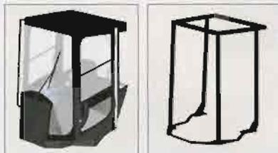
万が一の事故からオペレータを保護するため、キャブの構造内には、ISO規格に合格したROPSとFOPSを組み込んでいます。
