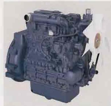
パワフルな作業を可能にする高出力エンジンを採用。ZW40/50では大きな排気量に加え、振動をおさえるために4気筒エンジンとしました。また、排気量が大きいため、作業時にエンジンの回転数を上げなくても、スムーズな稼働ができるうえ、燃費の削減も可能にしました。
