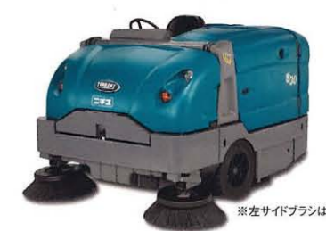
S30-S30XP D MLD 業界初のサイクロンフィルターを採用。粉塵の多いハードな現場にも対応します。
