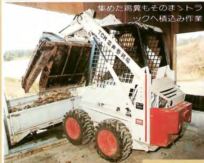
ウイングバケットを付けてゲージ下の鶏糞も残さずきれいにクリーンアップ
