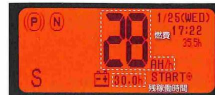
一目で現在の燃費状況が確認できます。燃費は1時間当たりの消費電流量、残稼働時間は現在の燃費で残り何時間稼働できるかの推定時間です。
