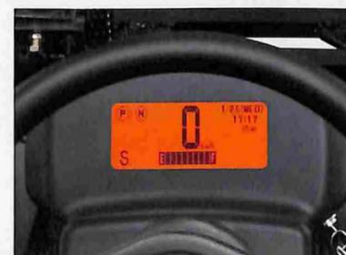
メーターパネルには、1時間当たりの電力消費量や稼働時間など、各種表示機能を搭載したマルチディスプレイを採用。現在の車両状況を一目で確認することができ、より意識的な省エネが可能です。
