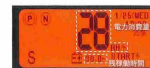
一目で現在の電力消費量が確認できます。電力消費量は1時間あたりの消費電流量を示し、同じ作業を続けた場合の推定残稼働時間も確認できます。
