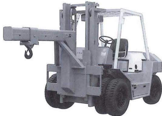
●構造は、フィンガーに特殊な形状をした逆L形アームを取り付け、その先にフックを取り付けています。フォークを下から差し込めない重量物や、袋物などを玉掛けて吊り上げて運搬作業を行えます。
