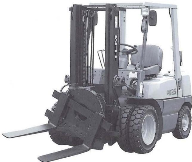
●フォークがリフトブラケット(フィンガバー)ごと左右いずれも360°連続無限に回転しますから、フォークまたはパレット上の扱物をスイングして出したり、フォーク差し込み付のボックスやバケットとの組合せでバラ物・液状物・生コンなどの運搬、サイドダンプ作業が容易に行えます。
