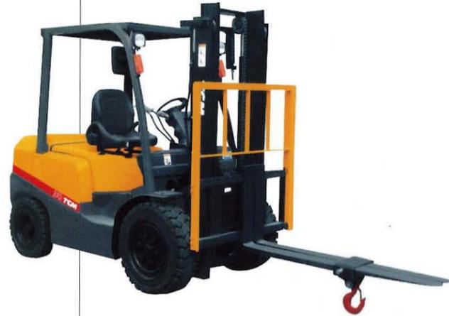
●標準フォークを使用して吊り上げ作業を行うアタッチメントです。2本のフォークを中心に寄せさせてフックブロックをはめ込み、側面から2本のボルトでフォークに締めつけると準備OK。粉体・粒体を入れたフレキシブルコンテナや袋物などフックに玉掛けし、吊り上げ作業に高効率を発揮します。取り外しも簡単ですから普通のフォーク作業も行えます。
