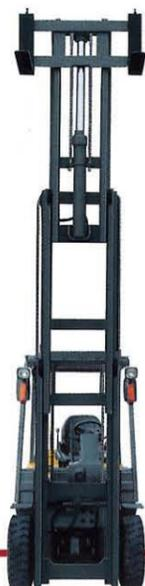
●フルフリー3段マストは、フルフリーマストとマストが3段に伸びる3段マストの両方の機能を持った作業用途の広いアタッチメントです。天井、出入口、障害物の高さなど、高さに制限がある所でも大きなフリーリフト量を持っているため楽々進入し、標準マストでは不可能な高積み作業を効率的に行え、限られたスペースを最大限に利用できます。2~3t車に4本シリンダ式を設定しています。
