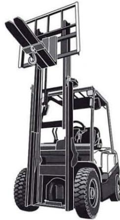
●標準フォークを使用して吊り上げ作業を行うアタッチメントです。2本のフォークを中心に寄せさせてフックブロックをはめ込み、側面から2本のボルトでフォークに締めつけると準備OK。粉体・粒体を入れたフレキシブルコンテナや袋物などフックに玉掛けし、吊り上げ作業に高能率を発揮します。取り外しも簡単ですから普通のフォーク作業も行えます。
