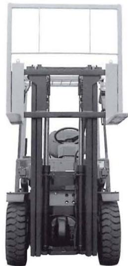
●フルフリーマストは、標準マストに比べて大きなフリーリフト量を持ち、フォークを上昇させてもフリーリフト内であれば、マスト高さが変わらないため天井の低い室内での荷役、たとえば船内、貨車内、コンテナ内でも天井高さを気にしないで作業効率を上げることができます。3本シリンダ式、4本シリンダ式があります。
