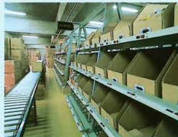
流動棚に取り付けられたアンサーキット
