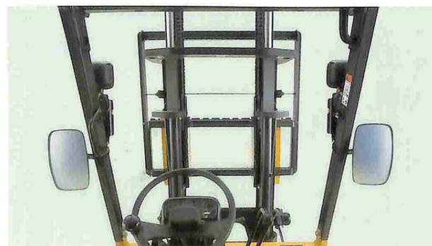
フィンガーバーの形状変更により、積み込み作業時の前方視界が大幅に向上しました。
