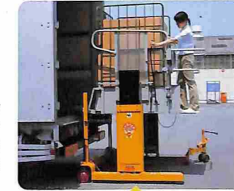
2 ステアリングレバーを立てて制動状態にします。コンセントをつなぎます。
