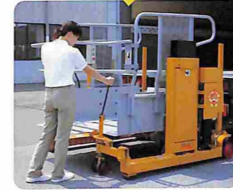
2 ステアリングレバーを立てて制動状態にします。コンセントをつなぎます。
