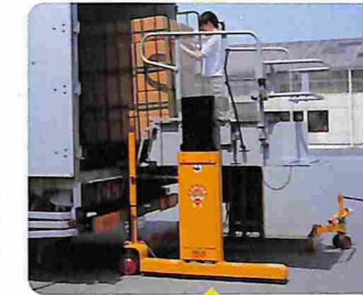
1 トラック荷台の後ろにリフターを手押しで移動します。
