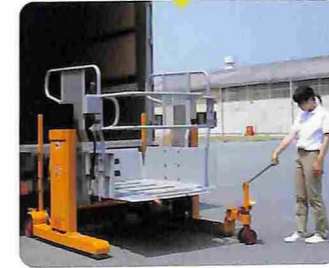
3 リフトテーブルを少し上昇させて後輪のアームを回転させて、リフトテーブルの下から引き出します。
