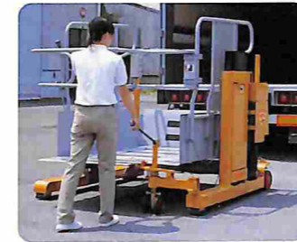
1 トラック荷台の後ろにリフターを手押しで移動します。
