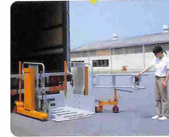
4 リフトテーブルを下降させて、オペレータガードを開けます。
