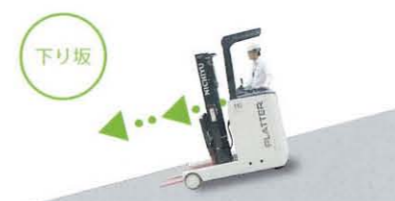
下り坂 安全な一定速度を維持します。(降坂時抑速回生) 積載時の下りは、後退で走行してください。
