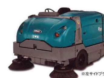
S30-S30XP D MLD 業界初のサイクロンフィルターを採用。粉塵の多いハードな現場にも対応します。
