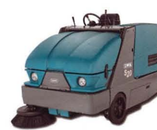
S20 E D MLD 粉塵を完全に抑えるサイクロンフィルターを中型乗用タイプに初めて搭載しました。
