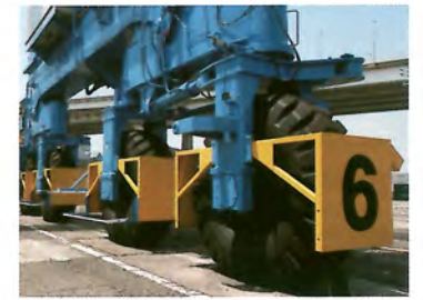
自動直進装置 (オプション) 業界初の連続磁気誘導方式
