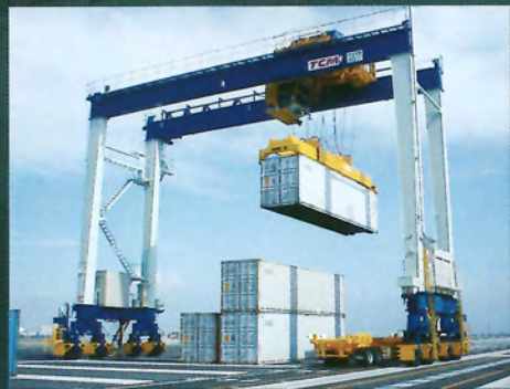
RTG (8輪) トランスファークレーン(タイヤ式) ディーゼルエレクトリック方式
