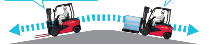
※安全確保のため、フットブレーキとの併用をおすすめします。 ※荷物積載時の降坂はバック走行でお願いします。
