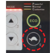
※カメラモード速度制限を選択した場合は、最も遅く設定した速度の方に優先されます。
