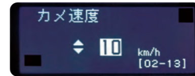
※カメラモード速度制限を選択した場合は、最も遅く設定した速度の方に優先されます。
