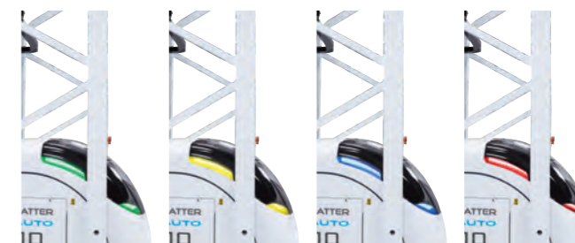
● 前进・後進 ● 荷役・旋回 ● 自動充電・待機中 ● 異常発生
