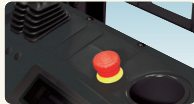
非常停止押しボタン
