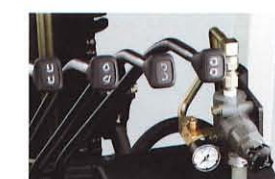
終段減圧弁 クランプ類等のアタッチメントの リリース圧を調整します。
