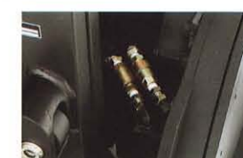
カプラー配管 アタッチメントの脱着を容易にします。
