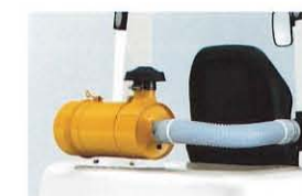
ドナルドソンサイクロバック カウンタウエイト上のエアクリナー を通過した吸入空気を、エンジンルーム 内のエアクリナーへ導きます。 ※ヘッドガード取り付けタイプもあります。
