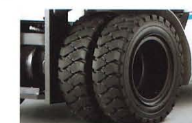
スペシャルダブルタイヤ 不整地や泥ぬい地に適した、太 ダブルタイヤです。
