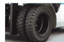
スタンダードダブルタイヤ 小回りが効き、屋内の高積み作業に 適した、細ダブルタイヤです。
