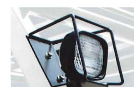
ヘッドランプガード 衝突など万一の際に、ヘッドランプ の破損を防ぎます。
