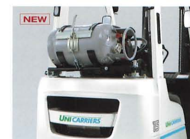
LPG仕様スイングダウン架台 (残量警告表示付) ボンベの交換作業が容易に行えます。
