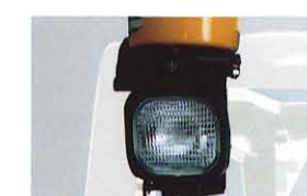
後方作業灯 後方を照射して、夜間や暗い倉庫で の作業に威力を発揮します。
