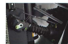
チルトシリンダーブーツ チルトシリンダーを塵埃等から保護 します。
