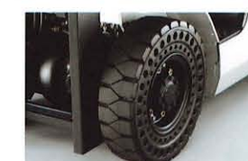
エアボスタイヤ ソフトな乗り心地と操縦安定性、 耐摩耗性を追求したノンパース ソリッドタイヤです。
