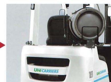
LPG仕様スイングオープン架台 (残量警告表示付)
