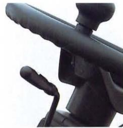
アクセルを踏み込んでいくと、最高速まで自動的に変速を行うオートマチックトランスミッションを採用。従来のわずらわしい変速操作の必要がなく、滑らかな発進、加速による優れた機動性を発揮します。また、前後進の切り換えは軽い操作の電気式チェンジレバで、スムーズに行えます。
