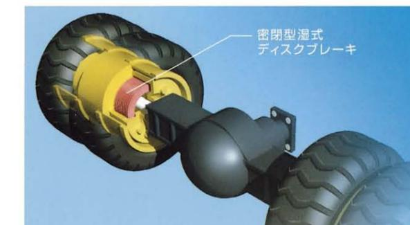
ブレーキは湿式ディスクタイプ(強制冷却システム付)を搭載。安定したブレーキ性能はもちろん、従来の乾式ディスクブレーキタイプのようなパッド摩耗がなく、メンテナンスコストを大幅に削減しました。
