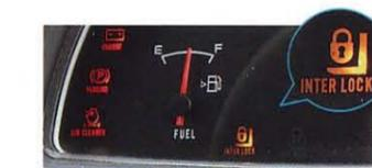
スタータスイッチがON位置のとき、シートから離れるとアラームが鳴ります。約3秒後に走行は中立状態で荷役はロックして警告灯が点灯します。
