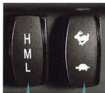
自動変速切換モードと1速固定モードの切り換えスイッチや、アクセルを踏んでも一定以上の速度が出ない制限速度モードへの切り換えが出来るスイッチを標準装備。作業環境に応じた最適な運転モードを選択できます。また、最高速度を予め一定速度に制限するオプションもご用意しています。
