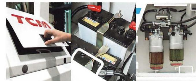
車体のサイドカバーはワンタッチで開閉可能で、カバー内にはそれぞれヒューズやリレーボックスなどの電装品、燃料ポンプや燃料フィルタ等の燃料系、そしてバッテリーを集中配置。メンテナンスがより容易に行えます。
