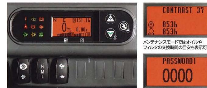
標準画面には走行速度計、燃料メータ、水温計、簡易荷重計(オプション)、アワメータなどを常時表示
