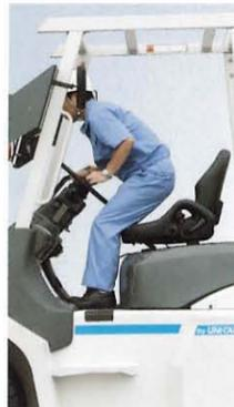
オペレータが正しい運転操作位置にいる場合のみ、走行・荷役操作が可能になる、インターロック機構を装備。オペレータの不安定な姿勢での作業や、誤作動による事故を未然に防ぐための安全装備です。
