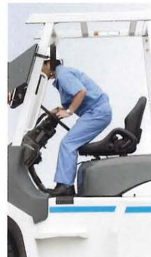
オペレーターが正しい運転操作位置にいる場合のみ、走行・荷役操作が可能になる、インターロック機構を装備。オペレーターの不安定な姿勢での作業や、誤作動による事故を未然に防ぐための安全装備です。
