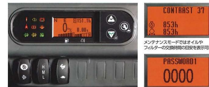
標準画面には走行速度計、燃料メーター、水温計、簡易荷重計(オプション)、アワメーターなどを常時表示
