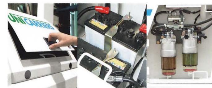
車体のサイドカバーはワンタッチで開閉可能で、カバー内にはそれぞれヒューズやリレーボックスなどの電装品、燃料ポンプや燃料フィルター等の燃料系、そしてバッテリーを集中配置。メンテナンスがより容易に行えます。
