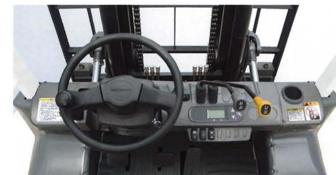
改良されたレバー類、新型メーターパネル、居住スペースの拡大された足元エリア、水はけのよいフロアマットなど、コックピットをアップグレード。ストレスフリーな操作性を実現しています。
