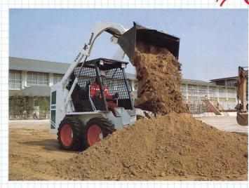
セルフレベリングバルブの採用で バケット水平を維持
