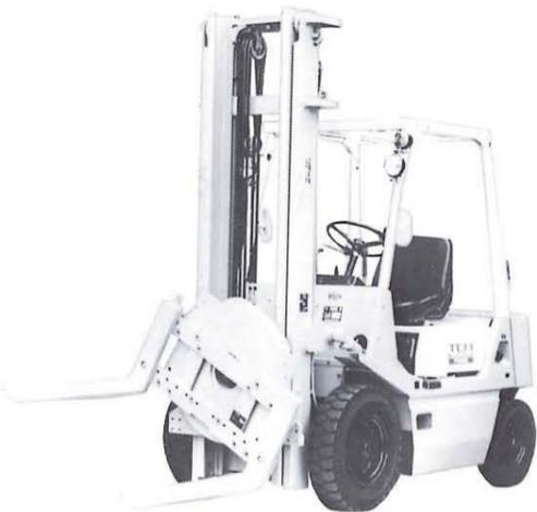
フォークがリフトブラケット (フィンガバー) ごと左右いずれも360°連続無限に回転しますから、フォークまたはパレット上の扱物をスイングして放出したり、フォーク差し込みみのボックスやパレットとの組合せでバラ物・液状物・生コンなどの運搬、サイドダンプ作業が容易に行えます。
