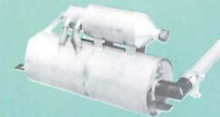
排気ガス浄化装置(触媒式マフラ)
