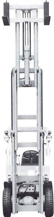
フルフリー三段マストは、フルフリーマストとマストが三段に伸びる三段マストの両方の機能を持った作業用途の広いアタッチメントです。天井、出入口、障害物高さなど、高さに制限がある所でも大きなフリーリフト量を持っているため楽々進入し、標準マストでは不可能な高積み作業を効率的に行えます。限られたスペースを最大限に利用できる、利用価値の高いマストアタッチメントです。
