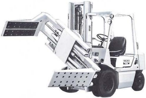
ロードグラブに回転装置を組合せたアタッチメントです。たとえば車体幅より大きい荷物を運搬する場合、通路幅が狭くても荷物を縦位置に回転させて通りぬけができるなど、通路、積付けの制約がある場合に最適なアタッチメントです。引込みタイプと引掛けタイプを用意しています。
