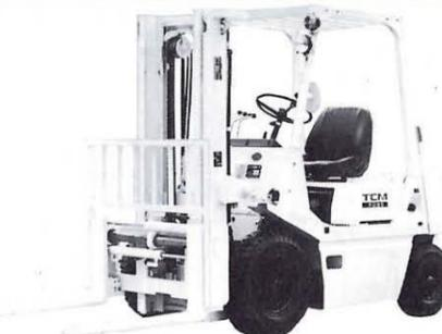
扱い物の種類が多様で、フォークさし込み口の位置が扱い物によって異なる場合、オペレータは作業前にその都度フォーク間隔を調整しておく必要があります。また大形フォークリフトのようにフォーク重量が重くなると人力で移動させるのが困難です。このような場合、運転席のレバー操作で自由にフォーク間隔が変えられるフォークシフト・アタッチメントが便利です。
