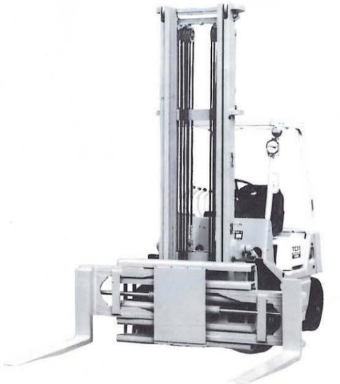
ロードグラブのアームを取り外し、アームのかわりにフォークを取り付けた機構になっています。原綿や袋物などを左右からはさみつけて運搬したり、一般のフォーク作業も行えます。左右のフォークは単独に作動する別動タイプ。小さな物から大きなものまで効率的に、位置ずれの場合でも繰り返し不要な効率よく作業できます。フォーク間隔は、標準形と広範囲形の2タイプを用意しています。
