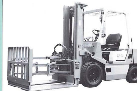
物流の効率向上とコスト低減を実現するシートパレットシステム――このシステムを支えるロードプッシュプルは、1本のレバー操作でシートパレットを「くわえる」「引込む」「荷物を押し出す」「パレットを離す」の一連のグリップ作動とプル作動を高効率にやってくれる。扱物品も米袋、肥料、食料品、水産物、製紙、化学薬品、繊維、建材など多くの業種に適します。すべてリテーナおよびサイドシフト装置付ですからキメ細かい作業が行えます。
