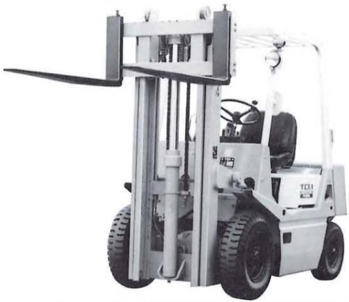
フルフリーマストは、標準マストに比べて大きなフリーリフト量を持ち、フォークを上昇させてもフリーリフト内であれば、マスト高さが変わらないため天井の低い室内での荷役、たとえば船内、貨車内、コンテナ内でも天井高さを気にしないで作業能率を上げることができ、しかもスペースを有効に利用できます。
