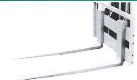
軽量で大容量の荷物を運搬する場合や、車両が扱いたい物に接近できず遠くからすくい込むときなどには、扱い物の大きさに応じて、長フォークが最適です。長フォークの種類も豊富ですから、扱い物にマッチした最適の形式をお選びいただけます。
