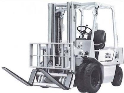
木材、鋼管、鉄棒、パイプなど扱いにくい長尺物を荷役運搬する作業性の高いアタッチメントです。フォークが上40°、下50°にヒンジ作動しますから、すくって抱え込み、ダンプ作業、スコップなどを装着してバケット作業、もちろん普通のパレット作業も行える一台3役の汎用性の高いアタッチメントです。
