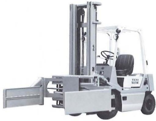
原綿や原麻、箱物、袋物などを両側からしっかりとらしてはさみ上げ、安全・確実に運搬します。パレットレス作業ができますから積込みスペースの有効利用やコストの低減にも役立ちます。左右のアームは単独で作動できる別動タイプです。そのためキメ細かい作業が可能。つかみ範囲は標準形と広範囲形の2タイプを用意。さらに2t系にはサイドシフト機構付も有り、更に特許でフォークアームタイプも有ります。
