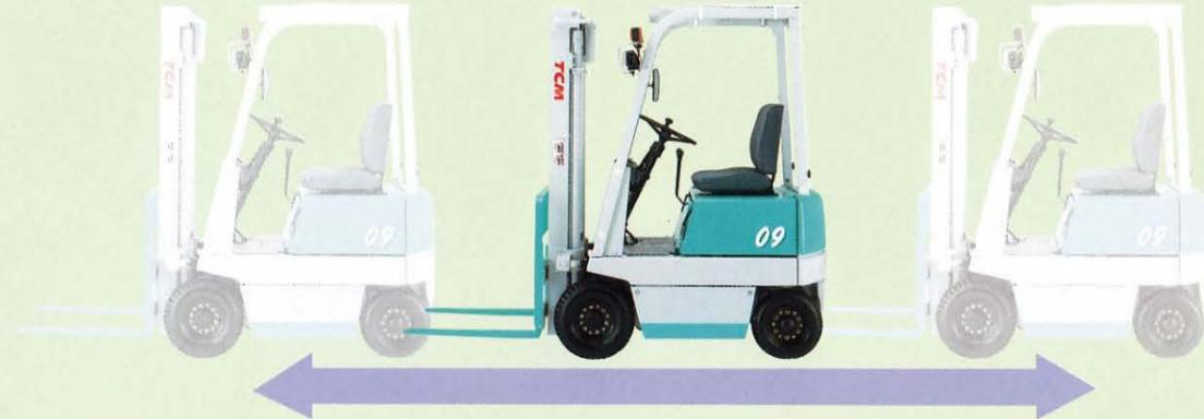
最高速度 **10.5km/h** FB07 **10km/h** FB09（無負荷時） 微速走行 **0.2km/h** FB07・FB09（無負荷時）
