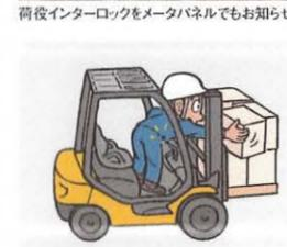
無人時の誤作動や不安定な姿勢での操作を防止するために離席時走行・荷役インターロック機構を装備。オペレータが着座しないと走行・荷役ができない、席を立つと走行・荷役系が停止する安心設計です。さらに走行中では、座席を立つとアラームが鳴り、その後着座しただけでは、作業が再開しない2重の安心構造。各種レバーを安全状態に戻せば、解除できます。
