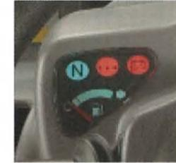
ギアがニュートラル状態になっていないと始動できないニュートラルスタート機構を標準装備。しかも、大きなインジケータでニュートラル状態をひと目で確認可能。
