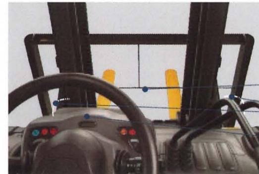
荷取り・荷置き時の死角を少なくするために、ティルトシリンダを低位置化、バックレストのロア・プレートを傾斜させました。また、ダッシュボードやセンタメータパネルのサイズ・レイアウト・形状もシミュレーション設計で最適化。前方視界を向上しています。
