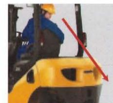
安全に後進できるように、カウンタウエイトの上部コーナーを傾斜化させて視界を向上。同時に視界に入るカウンタウエイト位置でフォークリフトの後端が分かる設計に。障害物との差を目で確認できます。
