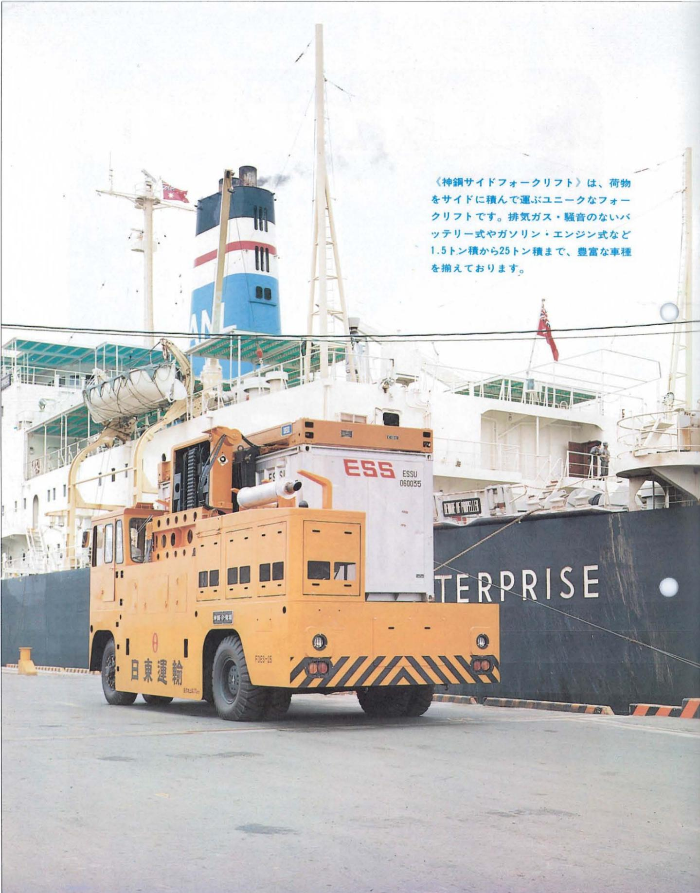
《神鋼サイドフォークリフト》は、荷物をサイドに積んで運ぶユニークなフォークリフトです。排気ガス・騒音のないバッテリー式やガソリン・エンジン式など1.5トン積から25トン積まで、豊富な車種を揃えております。
