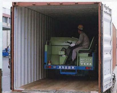
前輪の揺動機構により、斜面や凸凹の路面走行が可能。
