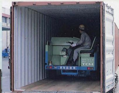
前輪の揺動機構により、斜面や凹凸の路面走行が可能。
