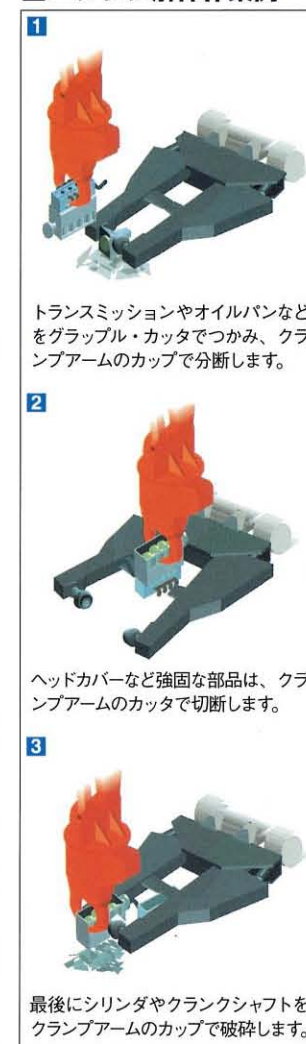
■エンジン解体作業例
