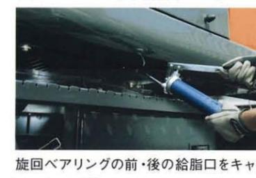
旋回ベアリングの前・後の給脂口をキャブ下面に再配置しました。オペレータは、より自然な姿勢で給脂を行なうことができます。
