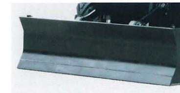
ブレードを曲面形状にして土掃け性を向上しました。ブレード底面は、ならし作業がきれいにできるフラット・ボトム形状を採用しました。なお、ブレード高さは標準ブレードより150mm低くなります。
