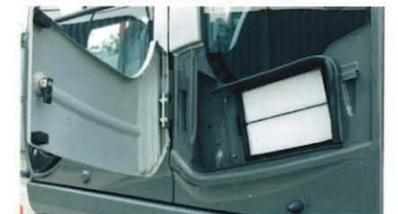
エアコン外気フィルタをキャブドア後方に設置しました。地上から容易に交換・清掃作業ができます。
