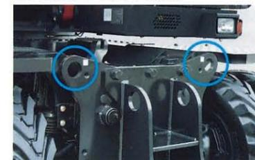
輸送時の機械固定用フック穴をトラックフレームの前後計4カ所に設けました。
