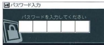
エンジン始動時に、3～5桁の暗証番号を正しく入力しないと始動しないテンキーシステムを採用。車両の盗難やいたずらなどを予防します。
