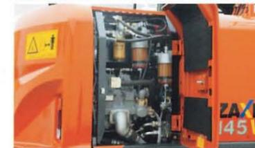
燃料ダブルフィルタ、エンジンオイルフィルタ、パイロットフィルタ、ブレーキフィルタを地上から点検・交換できる位置にしました。
