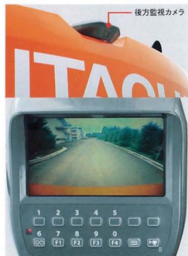
カウンタウエイト部に後方監視カメラを搭載。キャブ内のモニタで後方を監視でき、後進時の確認に役立ちます。
