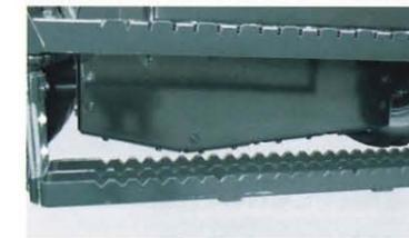
トランスミッション部を囲むカバーを設置しました。泥の付着を抑えるとともに、清掃性を向上させました。
