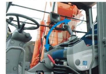
ロックレバーが完全にロックしていないとエンジンが始動できないニュートラルエンジンスタート機構を採用。レバーに触れていることに気づかずエンジンを始動して、急に機械が動いてしまうことを防ぎます。
