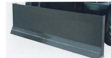
ブレード高さを増加しました。ガラなどの乗り越えを減少させることで、作業性が向上しました。ブレード底面は、ならし作業がきれいにできるフラット・ボトム形状を採用しました。
