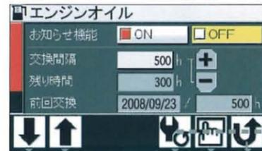
作動油や燃料フィルタの交換間隔を設定し、交換時期になるとモニタにメッセージを表示します。計画的なメンテナンスをサポートします。
