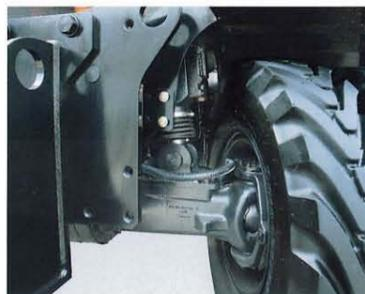
フロント油圧サスペンションを採用。走行中のショックを吸収し、オペレータの疲労を軽減します。
