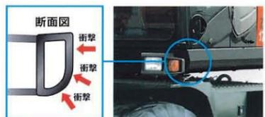
D型閉断面構造の大型フレームを採用し、外部衝撃に強い構造にしました。
