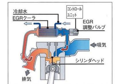
一度燃焼させた排出ガスの一部を吸入空気と混合し、再燃焼させる機構です。燃焼室内の酸素濃度を抑制することとEGRクーラにより燃料温度を下げることで、高出力を確保しつつ大気汚染物質であるNOx(窒素酸化物)の排出低減と低燃費を実現します。
