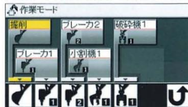
アタッチメント取付け時の煩雑な油圧回路切替えや流量切替は、「作業モード選択」画面からワンタッチ操作で行えるため、ブームや車体上でのバルブ切替作業は不要です。
