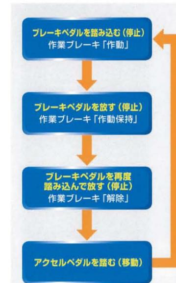
ブレーキペダルの操作で、作業ブレーキの『作動』『作動保持』『解除』が可能です。一度ブレーキを踏むと、作業ブレーキが作動し、もう一度踏むまでの間ブレーキ作動を保持します。これにより、従来機で行っていたコラム部の作業ブレーキ切替え操作が不要となり、オペレータは操作レバーから手を離すことなく、フロント操作とブレーキ操作を行うことができます。
