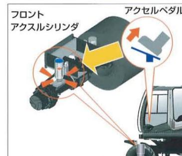
作業時にオートアクスルロックモードを選択した際、アクセルペダルから足を離すと、フロントアクスルシリンダが自動的にロックされます。そのため、機体の安定が高まり、微操作が要求される作業に集中することができます。
