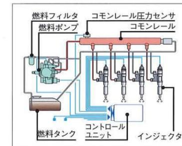
排出ガス3次規制に対応するため採用した新しいタイプの燃料噴射システムです。燃料ポンプを超高圧で駆動し、気筒ごとのインジェクタに燃料を分配して噴射するシステムです。さらに、電子制御により1,000分の1秒単位で燃料の噴射タイミング、噴射量をきめ細かに制御。この結果、燃料噴射量の最適化が図れ、高出力化ならびに不完全燃焼によるPM(黒煙などの粒子状物質)の低減や低燃費を実現します。
