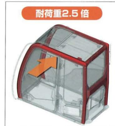
キャブの強度、剛性が大幅にアップし、転倒に対する安全性を向上。この構造は油圧ショベルの転倒時運転者保護構造であるROPS規格 (ISO 12117-2) に適合しています。例えば、キャブ上部に横方向の荷重を加えた場合、従来機ZAXISに比べ約2.5倍の荷重に耐えることができます。
