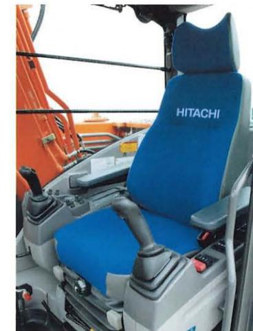
長時間のオペレーションを支えるための新設計。背もたれ部の幅を増大させホルド性を向上、ヘッドレスト形状見直しなど、オペレータと機械との一体感を高め、疲労を軽減する操作環境を実現しました。
