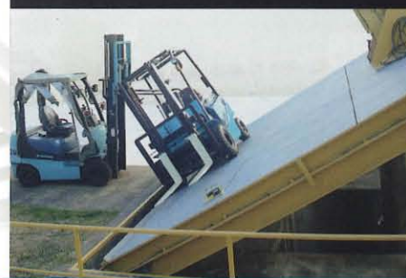
JIS D 6011に基づいた安定度試験の様子
