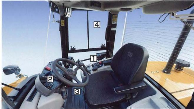
**ROPS** 転倒時運転者保護構造 (Rollover Protective Structure) **FOPS** 落下物保護構造 (Falling Object Protective Structure)
