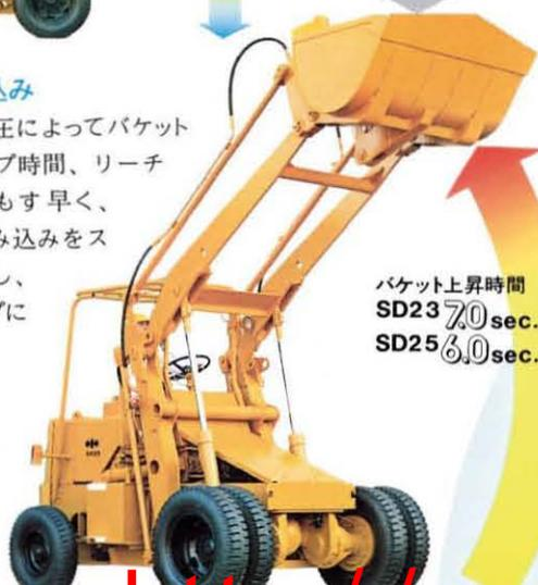
コマツショベルローダSD23・SD25は、運転操作がしやすく、軽快なトルクフロー式。またリンク機構はフロントエンドタイプで、ダンピングリーチ、ダンピングクリアランスいずれも大きく、優れたバケット上昇時間やけん引力などとあいまって過酷な作業でも力強くスピーディにこなします。さらに前方視界も良好で、コンパクトなボディをフルに生かして作業を迅速にすすめます。
